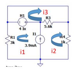
$$i_{1} \cdot R_{1} - 4V_{x} + i_{2} \cdot R_{3p2} - i_{3} \cdot R_{3p2} + i_{2} \cdot R_{4} = 0$$
